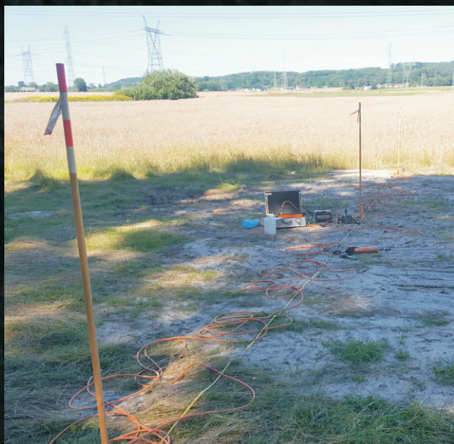
Pomiary rezystywności elektrycznej metodą tomografii elektrooporowej ERT.
