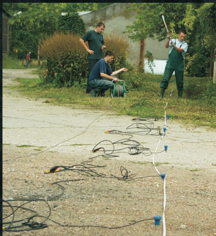
Pomiary sejsmiczne w celu rozpoznania geotechnicznego pod projektowaną zabudowę mieszkaniową.
