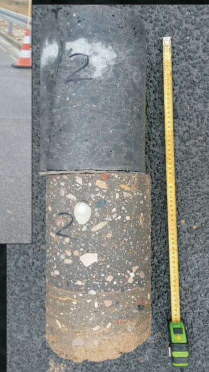
Wiercenie mechaniczne w warstwach nawierzchni autostrady w miejscach stwierdzonych usterek (u góry) oraz pozyskany rdzeń z dwóch wierzchnich warstw betonu z widocznym pęknięciem w górnej części, przedzielonych geowłókniną (po prawej).
