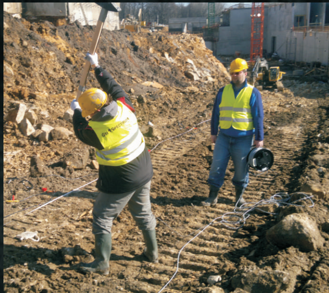
Pomiar sejsmiczny MASW w celu wykrycia stref spękań i rozluźnień na terenach pogórnich.
